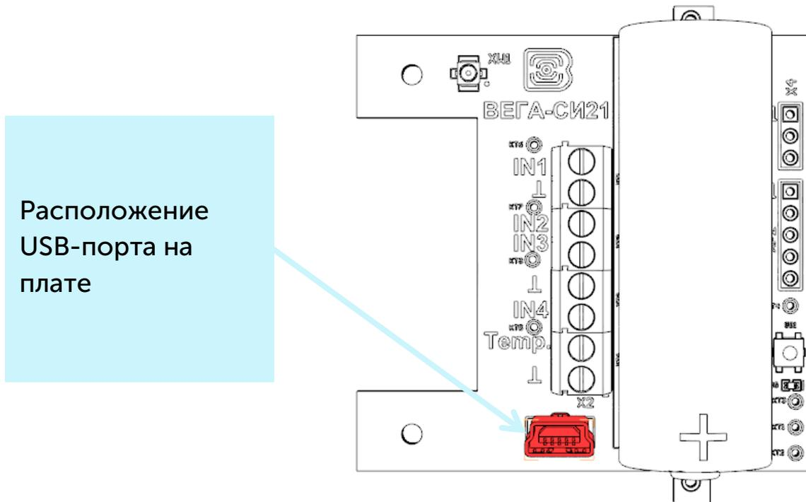
Перед первым подключением устройства к компьютеру необходимо установить драйвер для COM-порта **stsw-stm32102**, который можно скачать на сайте [iotvega.com](http://iotvega.com). После запуска исполняемого файла **VCP\_V1.4.0\_Setup.exe** появится окно установщика:
